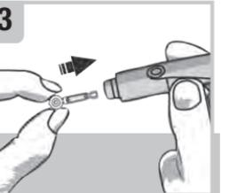
Inserte la lanceta en el dispositivo de punción hasta que encaje.
