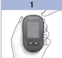
Pulse y suelte ① para encender el medidor. El símbolo de la tira reactiva parpadeando aparece en la pantalla. Pulse y mantenga pulsado ② hasta que aparezca set-up en la pantalla.
