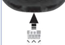
Inserte la tira reactiva en el medidor según la dirección de las flechas. Coloque el medidor en una superficie plana.
