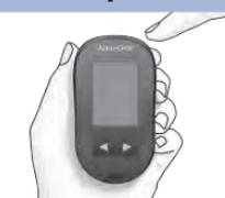
Pulse y suelte ① para encender el medidor. El símbolo de la tira reactiva parpadeando aparece en la pantalla.
