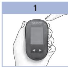
Pulse y suelte ① para encender el medidor. El símbolo de la tira reactiva parpadeando aparece en la pantalla. Pulse y mantenga pulsado ① hasta que aparezca **set-up** en la pantalla.
