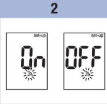
Pulse y suelte ③ repetidamente hasta que aparezcan el símbolo de la señal sonora parpadeando y On u OFF en la pantalla.
