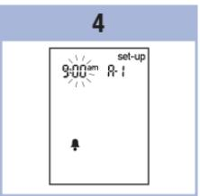
Pulse y suelte ② o ③ para ajustar la hora. Pulse y suelte ① para guardar la hora. Los minutos parpadean.
