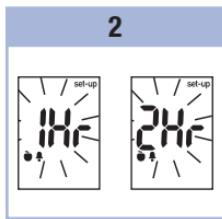
Pulse y suelte ③ repetidamente hasta que aparezcan **set-up** y **1Hr** o **2Hr** parpadeando en la pantalla.
