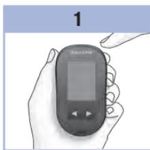
Pulse y suelte ① para encender el medidor. El símbolo de la tira reactiva parpadeando aparece en la pantalla. Pulse y **mantenga pulsado** ② hasta que aparezca **set-up** en la pantalla.
