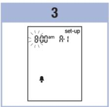
Pulse y suelte ② o ③ para seleccionar **On** u **OFF**. Pulse y suelte ① para guardar su selección. Si selecciona **On**, la hora parpadea.
