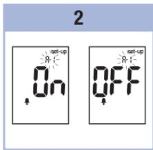
Pulse y suelte ① repetidamente hasta que aparezcan el símbolo de la campana, **OFF**, **set-up** y **A-1** parpadeando en la pantalla.
