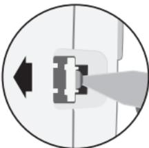
Abra la tapa del compartimento de las pilas a prueba de niños introduciendo un objeto estrecho, como un bolígrafo, en la ranura. Empuje la pestaña en la dirección de la flecha y levante la tapa del compartimento de las pilas.
