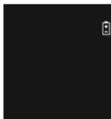
Las pilas están casi gastadas. Cambie las pilas ahora. Si el símbolo aparece de nuevo después de haber cambiado las pilas, vuelva a retirar las pilas, pulse y mantenga pulsado el botón Power/Set/OK durante al menos 2 segundos y vuelva a insertar las pilas.
