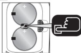
Pulse el botón
